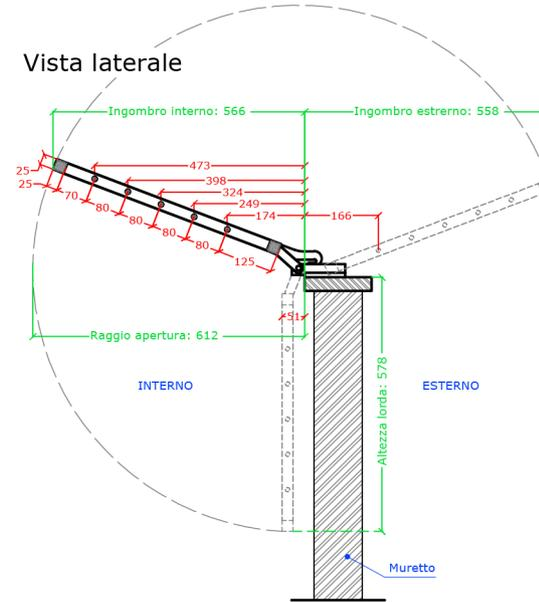
Particolare montaggio morsa (Modalità "A")
